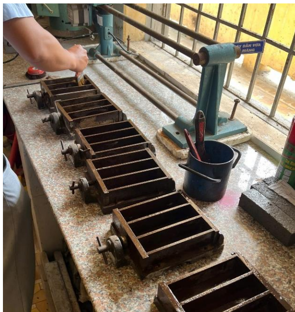
Hình 6. Quét lớp dầu nhót để chống dính vữa vào khuôn đúc.
