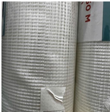
Hình 11. Vật liệu lưới GFRP (Glass Fiber Reinforced Polymer).
