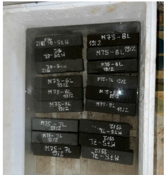
Hình 8. Mẫu sau khi đúc và bảo dưỡng.
