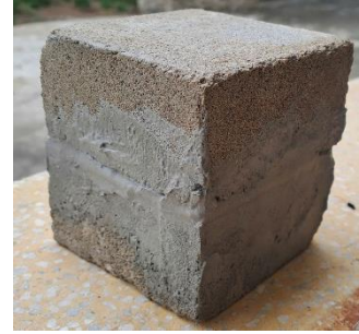
Hình 10. Kích thước mẫu nén xác định cường độ gạch.
