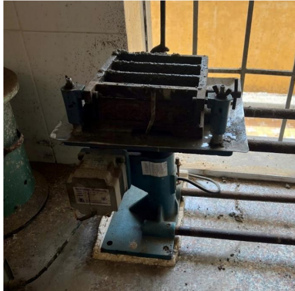
Hình 7. Dụng máy đầm để đảm bảo mẫu vữa đặc chắc.
