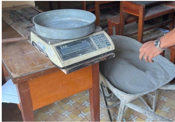
Hình 5. Dùng cân để tính khối lượng vữa khô trước khi trộn với nước.
