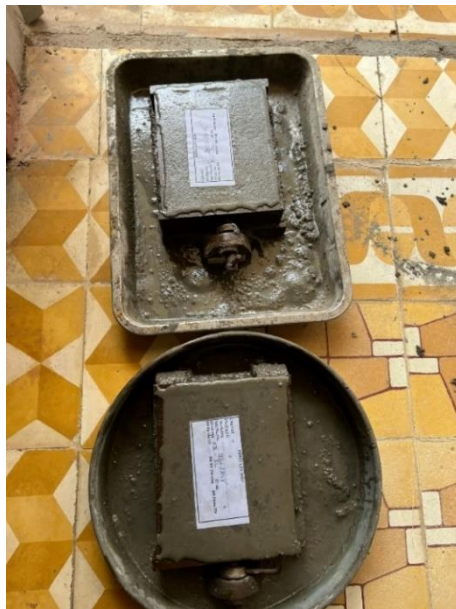
Hình 8. Mẫu sau khi đúc và bảo dưỡng.
